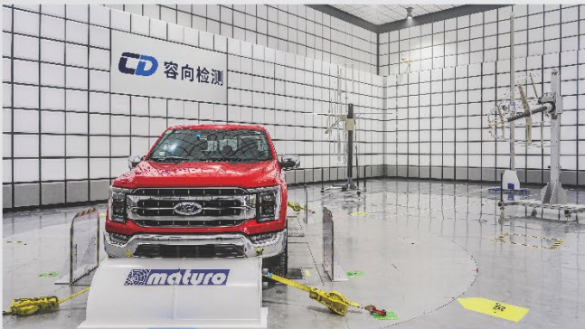
10米法汽车整车EMC试验室
